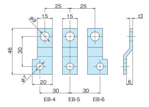
質 ●銅板(Cu) 表面処理 ●ニッケルめっき Material ● Copper Finish • Nickel plating
